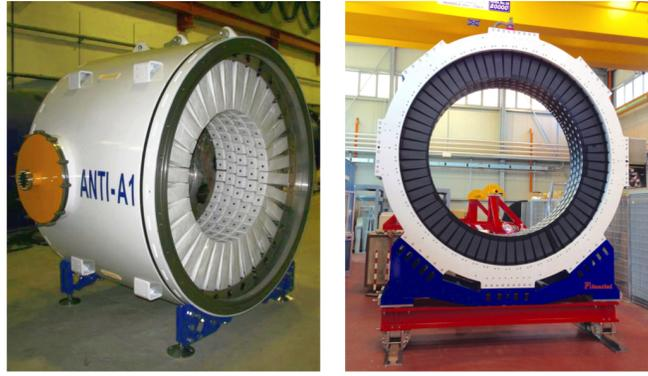
Figura 2.10: Izquierda: Estaciones LAV1 completas. Derecha: LAV12 antes de insertarse en la línea del haz
