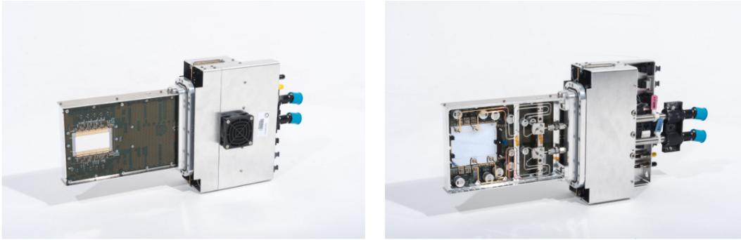
Figura 2.8: Derecha: imagen de una estación ensamblada en el lado del sensor. Izquierda: La estación ensamblada del lado del enfriamiento
