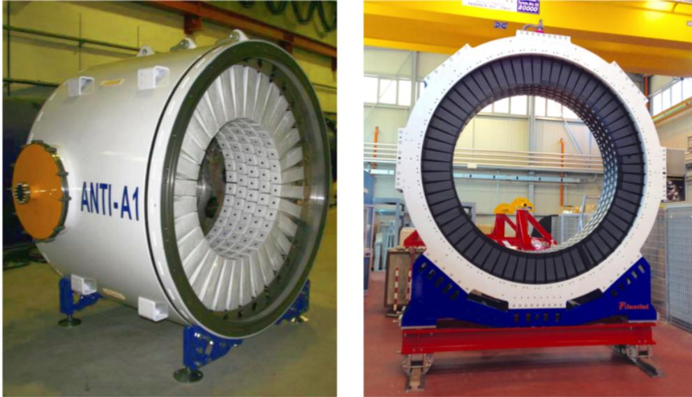
Figura 2.9: Estaciones LAV1 (izquierda) y LAV12 (derecha) antes de insertarse en la línea del haz [52].
