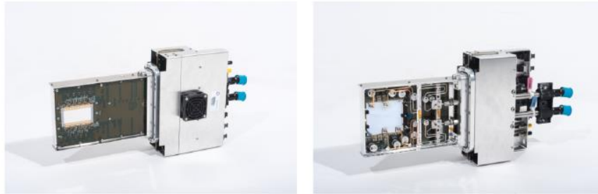
Figura 6.8: Derecha: imagen de una estación ensamblada en el lado del sensor. Izquierda: La estación ensamblada del lado del enfriamiento.
