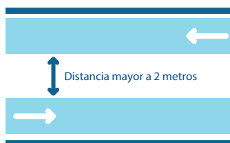
Figura 15. Señalización de sentidos de circulación.
